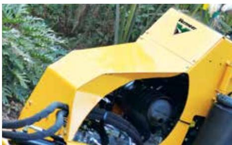
**RIDUZIONE DEI TEMPI DI MANUTENZIONE E DI SOSTITUZIONE PARTI.** Si sa, la manutenzione non è un optional. Il design della protezione del motore consente l'accesso ai punti di manutenzione quotidiana e settimanale senza l'utilizzo di strumenti, accelerando i tempi di assistenza.
