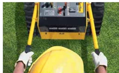
**SISTEMA DI STERZO VZ.** Invece di utilizzare leve aggiuntive e volanti, l'operatore può manovrare la macchina usando solo due barre manuali, che forniscono una leva maggiore quando si lavora in terreni sfavorevoli.
