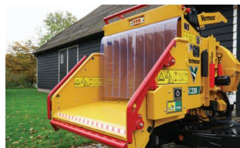
**SMARTFEED.** Il Sistema SmartFeed monitora i giri motore e, in automatico, ferma ed inverte il movimento dei rulli di alimentazione per migliorare la produttività. Questo sistema rileva anche il blocco di materiale nei rulli e gestisce il materiale in automatico, per ridurre l'uso della barra manuale di controllo.
