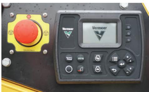
**SISTEMA DI CONTROLLO MOTORE ECOIDLE™.** Quando l'operatore seleziona il sistema EcoIdle, i giri motore diminuiscono ad una impostazione predefinita di giri/minuto dopo 1 o 5 minuti di inattività, per ridurre il consumo di carburante quanto non si cippa del materiale. Questo sistema aiuta a ridurre emissioni e rumore.
